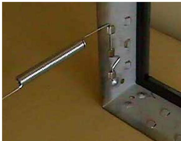
**FIGURE 118 - CORRECT LATCHOUT/KNOCKOUT CONFIGURATION (P/N 026-35778-006)**
