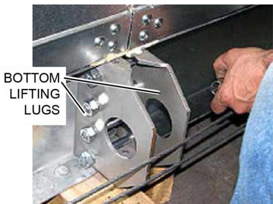
**FIGURE 38 - FASTEN BOTTOM LIFTING LUGS**
